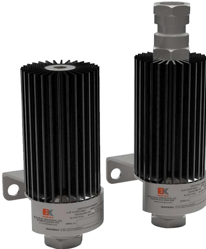
La gamme de thermostats FXT reflète le design des autres gammes FX de réchauffeur d'air; le tube à ailettes en aluminium extrudé peut être monté à la verticale sur un support ou un rail. Le thermostat peut être associé avec le réchauffeur FXE ou utilisé indépendamment avec les câbles fournis en les faisant passer à travers un presse-étoupe.
